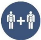
Nombre de personnes pouvant utiliser simultanément le système de protection antichute : en cas d'utilisation par 1 + 1 personnes, le système peut être utilisé par deux personnes en même temps, mais la fonction antichute ne peut être garantie que si les chutes ne se produisent pas en même temps.
